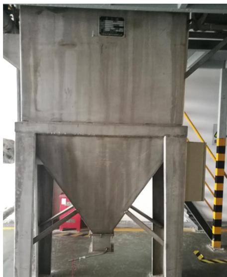
图 4.7 包装工序袋式除尘器
